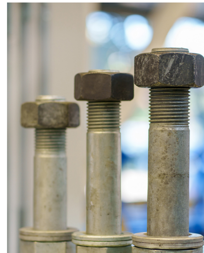
oben: Schraubenprüfstand in Aktion; unten links: Zur Veranschaulichung: unterschiedliche HV-Garnituren großer Abmessungen; unten rechts: Maik Dörre mit einer Schraube der Abmessung M 64 (Foto: Danny Gohlke)
