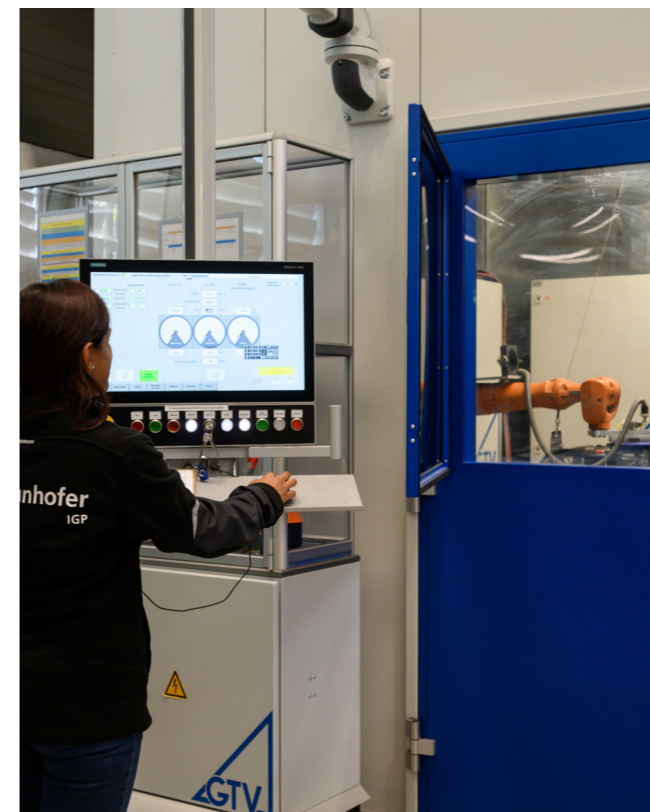
oben: Im Einsatz – Probenbeschichtung im neuen Hochleistungs-Beschichtungszentrum des Fraunhofer IGP; unten links: Pratidhwani Biswahl an der vollintegrierten SPS-Steuerung des Beschichtungszentrums; unten rechts: Brennertyp Shark400RE zum Lichtbogendrahtspritzen
