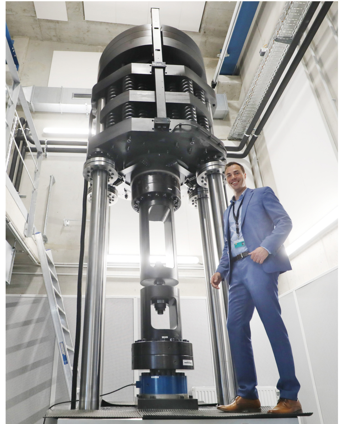
Holger Brauns, Prüflaborleiter am Fraunhofer IGP, vor der neuesten Prüfmaschine des Instituts, einem 2MN Resonanzpulsator (Foto: Danny Gohlke)
